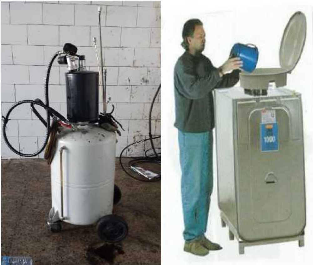
Fig 1.5. Aspirateur des huiles usagées Fig1.6. Cuve de stockage des huiles usagées
